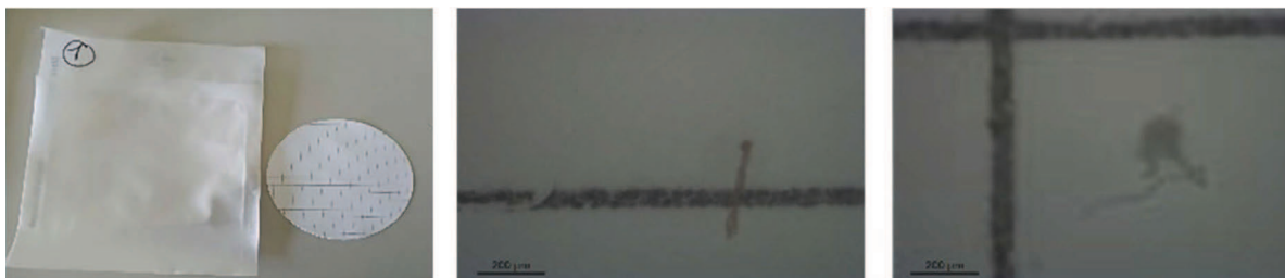
Bild 8 — Beispiele für Verunreinigungen in einem sauberen Filter
