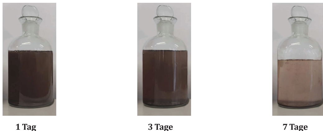
Bild 24 — Wasserprobe zu unterschiedlichen Zeitpunkten, die zuvor mit einer Wasserstoffperoxid-Lösung mit 15 % Volumenanteil behandelt wurde
