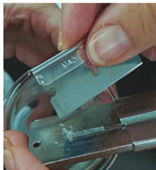
Bild 9 — Zuschneiden der Fasern mit einer Klinge
