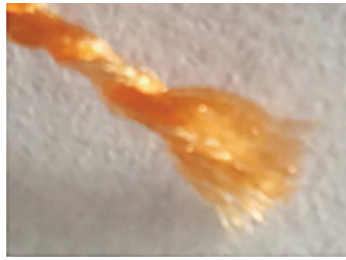
Bild 4 — Polyamid-Faden mit 180 Filamenten
