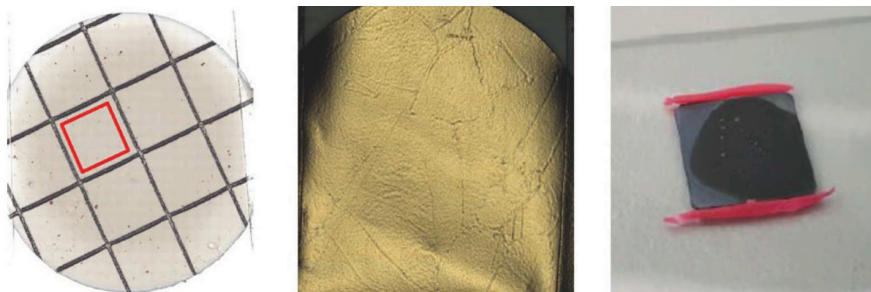
Bild 2 — Celluloseacetatfilter, goldbeschichtete Polycarbonat-Membran und Siliciumfilter
