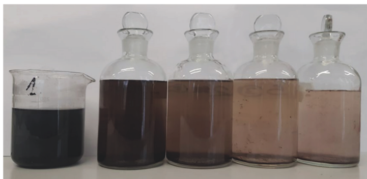
Bild 23 — Wasserproben, die mit unterschiedlichen Volumen einer Wasserstoffperoxid-Lösung mit 15 % Volumenanteil behandelt wurden
