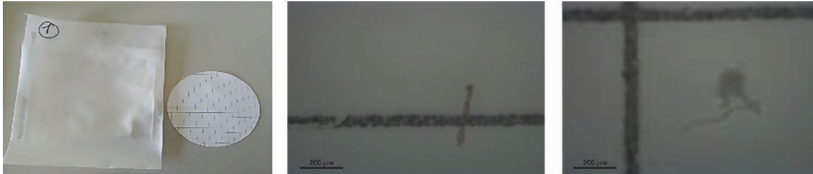
Bild 14 — Beispiele für Verunreinigungen in einem sauberen Filter
