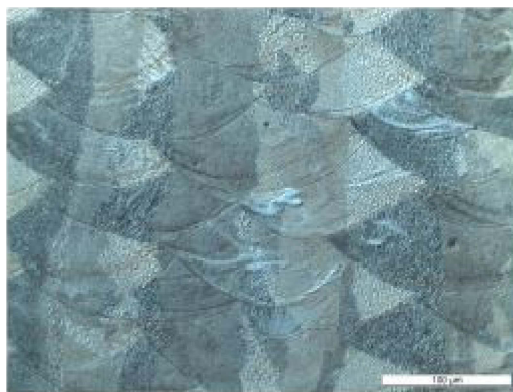
a) Längsschnitt eines Bauteils aus dem Werkstoff 1.2709
