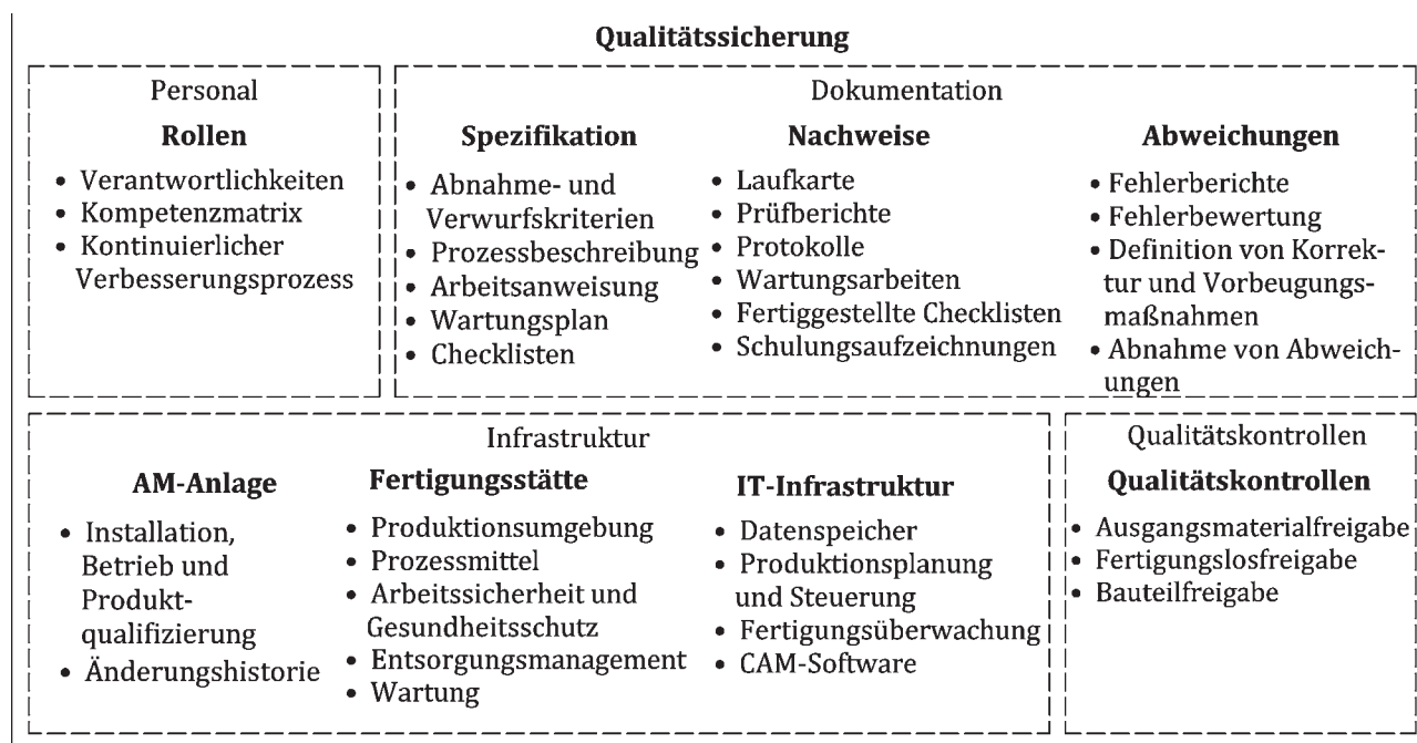
Bild 7 — Elemente der Qualitätssicherung
