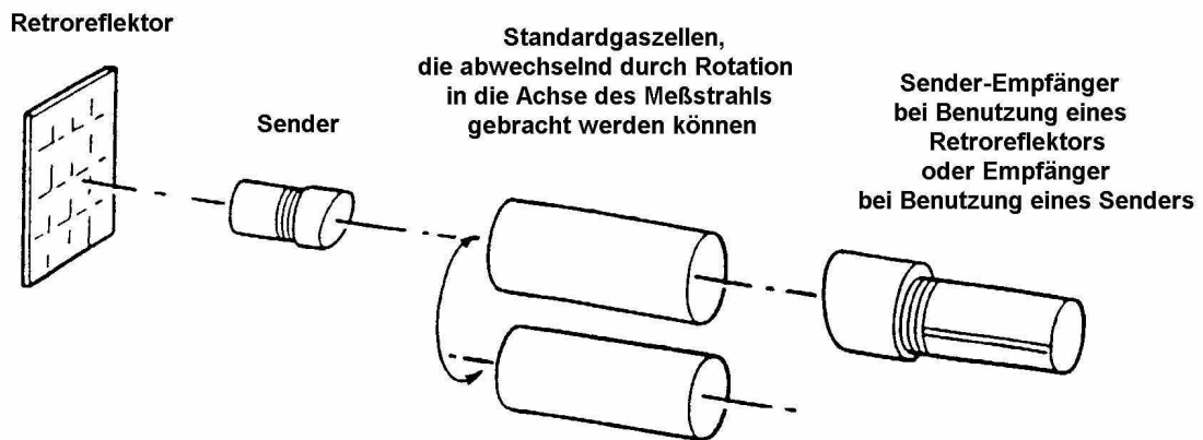
Bild 1 - Vorrichtung zur Gaskalibrierung und zur Prüfung der Ansprechgeschwindigkeit
