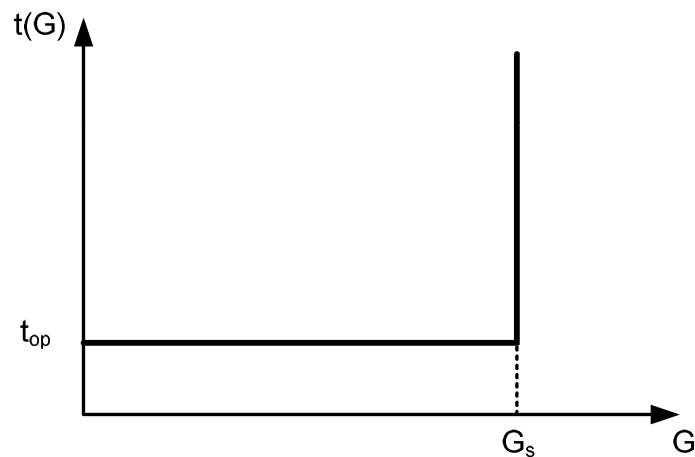
Bild 3 – Kennlinie des unabhängigen Zeitverhaltens bei Unterspannung
