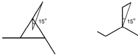
Bild 4 – 15° Phasendrehung wird vorzugsweise durch erweiterte Dreieck- oder Zickzack-Schaltung erreicht
