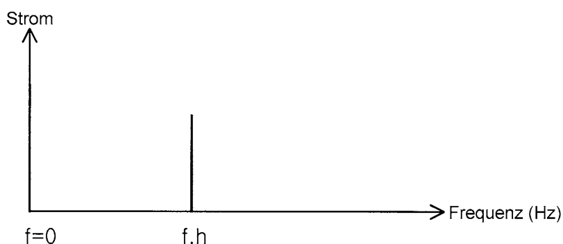
Bild 6.7 – Beispiel eines Spektrums von Strömen durch eine HGÜ-Glättungsdrossel
