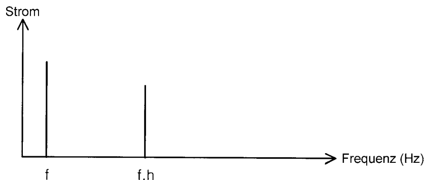
Bild 6.5 – Beispiel eines Spektrums von Strömen durch eine Wechselstrom-Filterkreisdrossel
