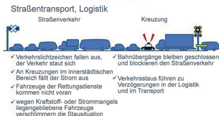
Bild 1 – Auswirkung eines Stromausfalls in einem Verkehrssystem
