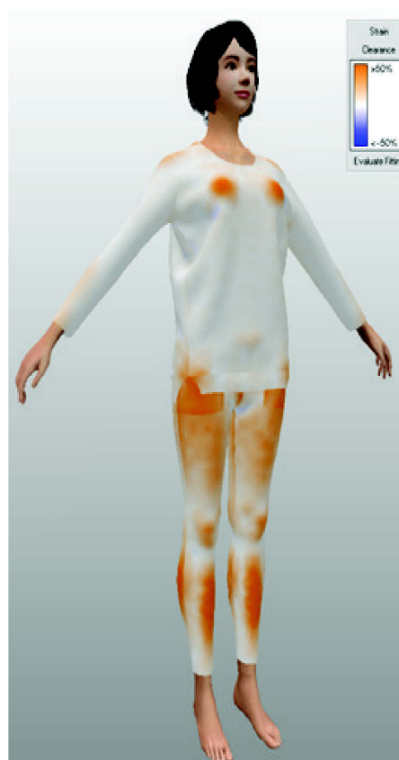
Bild 6 — Beispiel für die Visualisierung der Abstände per Musterdehnung und Farbskala
