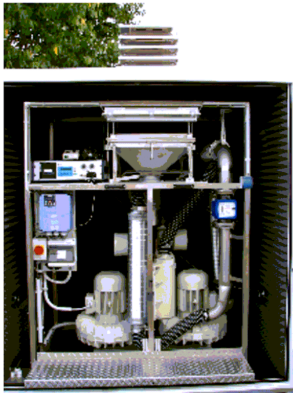
Bild 3 – Beispiel einer Probenahmekonfiguration für aerosolgetragene Radionuklide mit einem integrierten Filter
