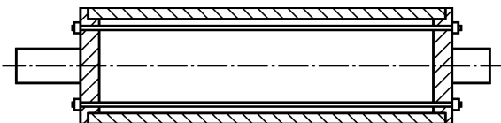
c) körperelastisches Verhalten (z. B. eine Trommel mit Zugankern, die elastisch unter der Fliehkraft ausbiegen)
