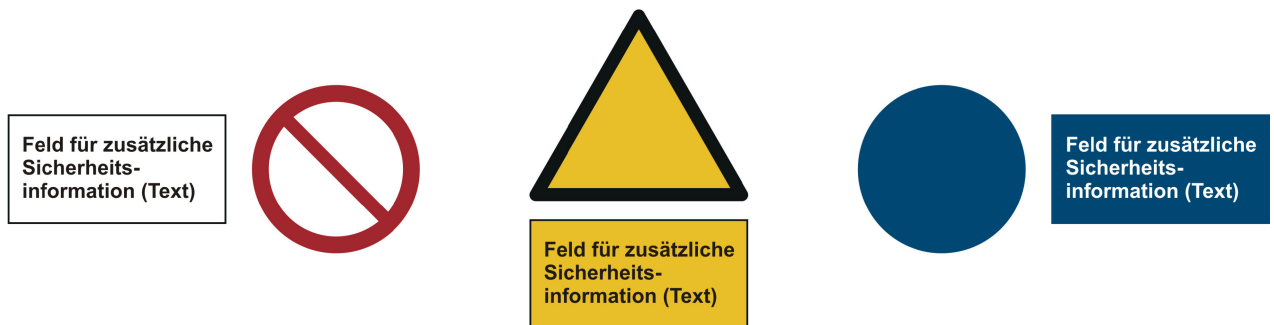
Bild 2 — Gestaltung von Sicherheitszeichen, die zusammen mit einem separaten Feld für zusätzlichen Sicherheitsinformations-Text verwendet werden
