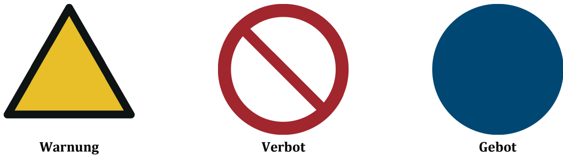
Bild 1 — Gestaltung von Sicherheitszeichen nach ISO 3864-1
