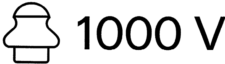
Bild 1. Beispiel einer Kennzeichnung nach DIN 48 699 mit Spannungsangabe 1000 Volt
