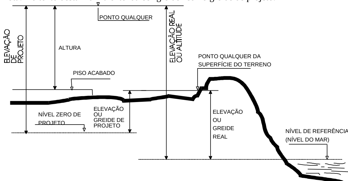
FIGURA 1 - INDICAÇÃO DE ALTURA, NÍVEL E ELEVÇÃO
