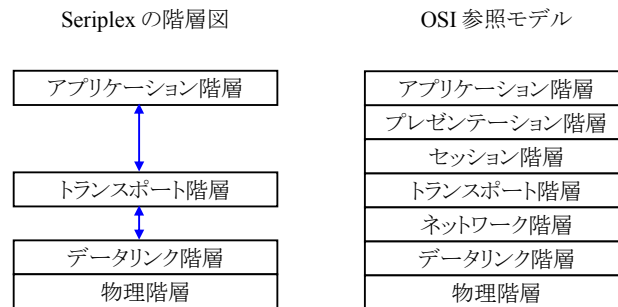
図 1 Seriplex の階層図 (Layered View of Seriplex)
