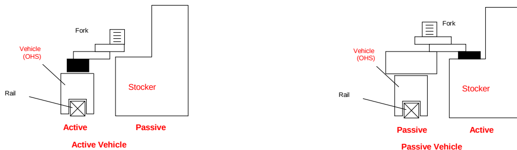
図 2 ベイ間の自動材料搬送システム装置の例 (ストッカー, OHS)
