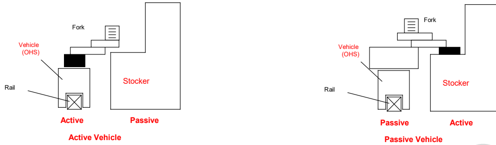
Figure 2 인터베이 자동 재료 처리 시스템 장비의 예 (스토커 및 OHS)
